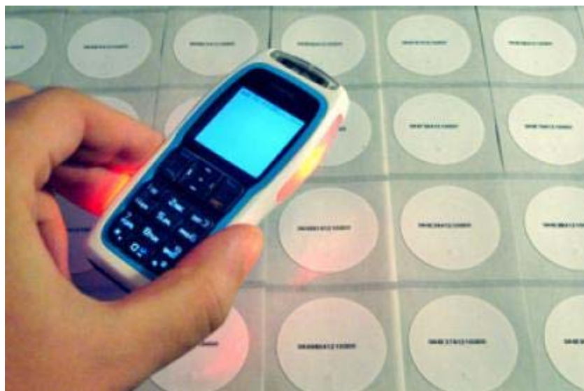
Figura 2. Lector RFID incorporado en un teléfono móvil Nokia leyendo información de etiquetas RFID.
