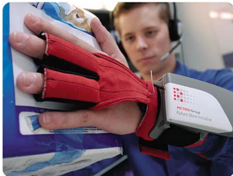
Figura 1. Guante con lector RFID incorporado que permite recoger información de los objetos con solo tocarlos.
